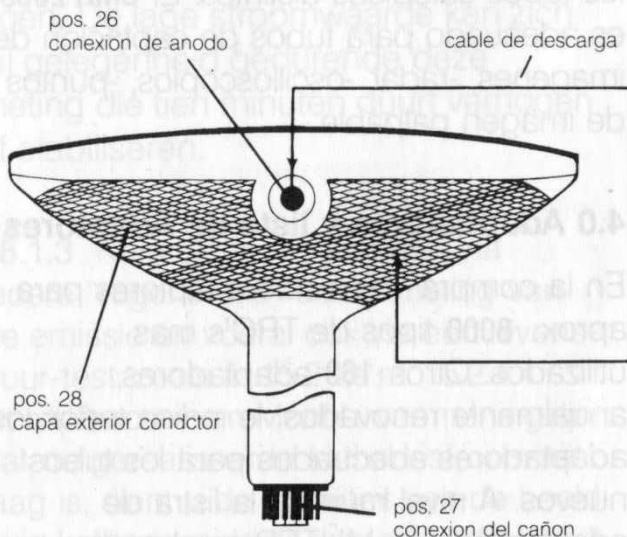
1 - 2: Descarga de un tubo de imagen
